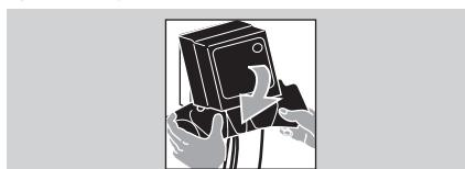
**2** Вставьте открытые края защитного чехла в зазор между автоматом управления горелкой и монтажной пластиной.
