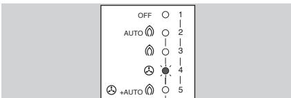
**!** При запуске горелки автомат BCU не распознает пламя в течение времени безопасности. При настройке параметра «Количество попыток перезапуска» можно настроить до 3 попыток перезапуска. Если одна из последующих попыток перезапуска увенчается успехом, сообщение о неполадке автоматически отменяется по окончании времени дополнительной продувки.
