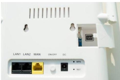
Перед запуском инкубатора, распакуйте роутер и вставьте СИМ карту в слот, как показано на картинке, затем распакуйте аккумулятор для роутера, вставьте один конец аккумулятора в роутер, а второй в разъём, который вставляется в электрическую розетку. Разъёмы у аккумулятора разные, перепутать и не тот разъём вставить в роутер невозможно. Аккумулятор для роутера необходим для того, что бы в случае отключения электроэнергии вы получили сообщение об этом на телефон в виде Push уведомления.
