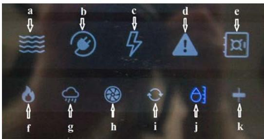
Панель индикации узлов имеет два ряда значков. Верхний ряд значков сигнализирует об аварии того или иного узла. Нижняя панель индикации показывает, какой узел или блок инкубации задействован прямо сейчас, в режиме реального времени. Ниже приведен список расшифровки значков.
