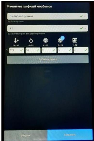
В данном режиме можно по дням забить режим рассчитанный уже на вывод цыплят и использовать этот инкубатор или одну камеру инкубатора исключительно под вывод цыплят. Поворот лотков в этом случае осуществляться не будет и инкубатор будет строго держать те параметры, которые вы укажите по дням инкубации.
